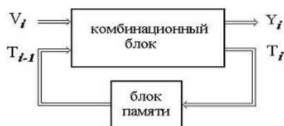
Рисунок 1 – Модель синхронной последовательностной схемы
