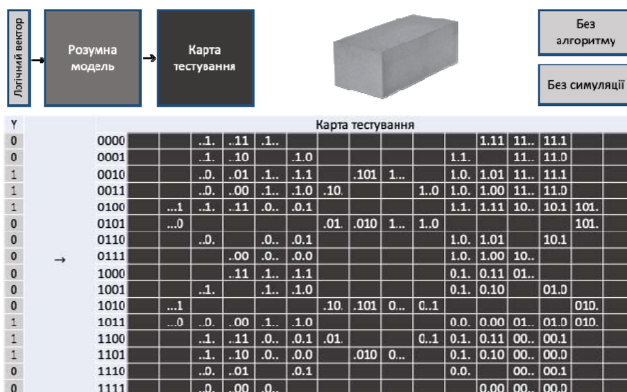
Рисунок 6 – Карта тестування несправностей для логіки 0011100000011100
