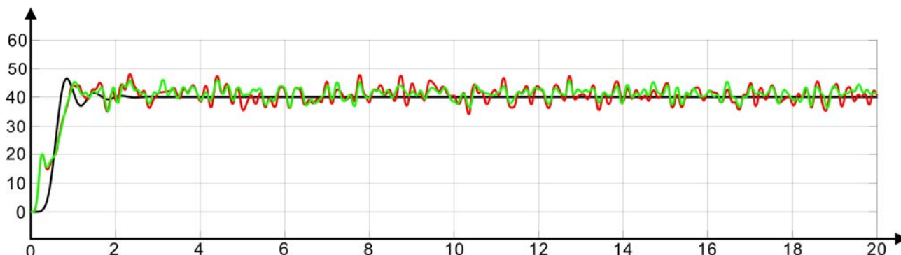
Рисунок 4 – Емпіричні результати вимірювань: чорна лінія – істинне значення кута, червона лінія – оцінка класичним методом, зелена лінія – оцінка модифікованим методом
