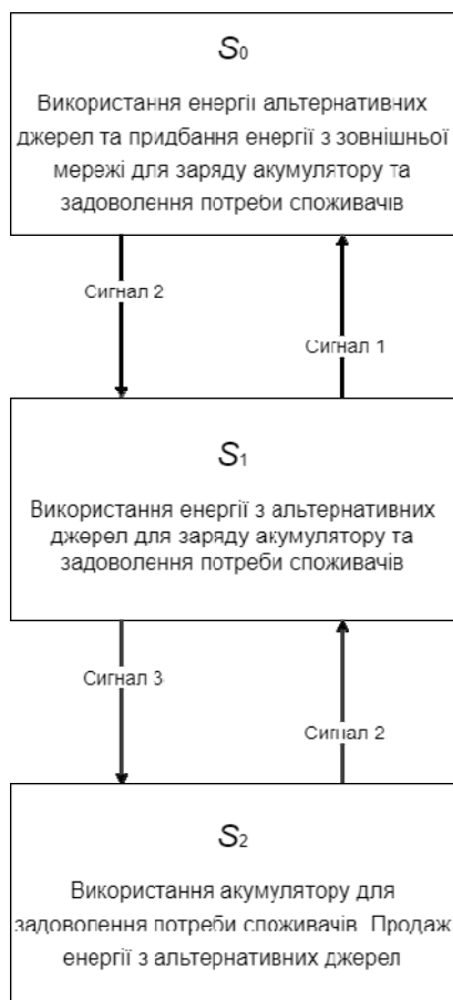
Рисунок 6 – Модель Кріпке електронезалежної станції альтернативної енергетики
