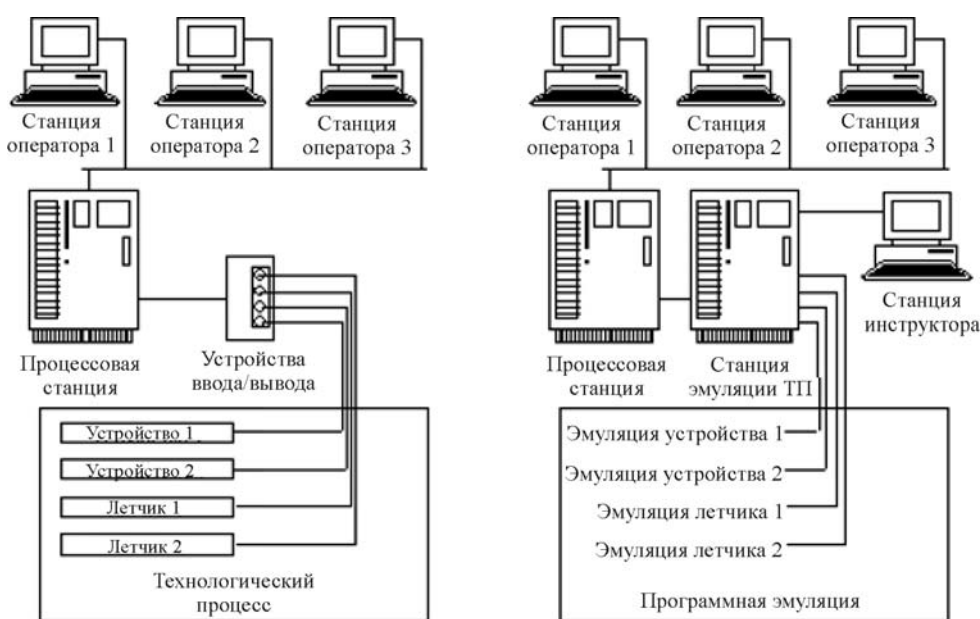
Рисунок 1 – Упрощенная система управления metsoDNA фирмы Metso Automation
