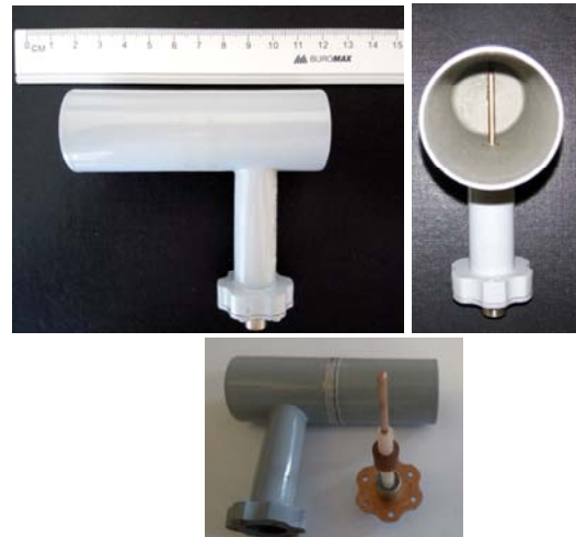
Рисунок 2 – Дослідний зразок антени у вигляді відкритого кінця круглого хвилеводу, що живиться КЛ із ЦДУТ
