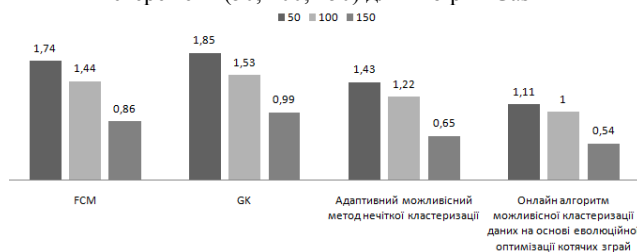
Рисунок 2 – Діаграма залежності похибки від кількості спостережень (50, 100, 150) для вибірки Glass
