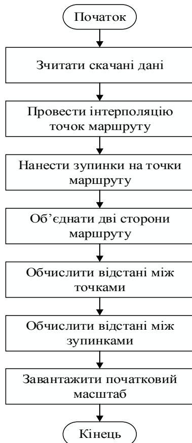
Рисунок 4 – Алгоритм опрацювання GTFS-даних
