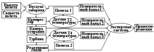
Рисунок 6 - Пример диагностики параметров датчиков и ГТД
