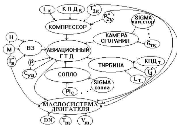
Рисунок 5 - Концептуальная модель ГТД и одна из его подсистем
