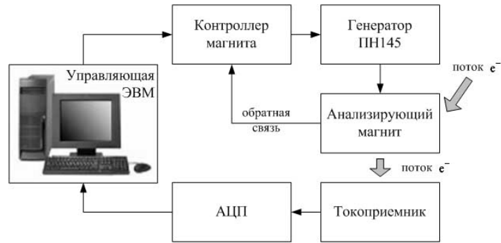
Рисунок 1 – Система управления магнитным спектрометром
