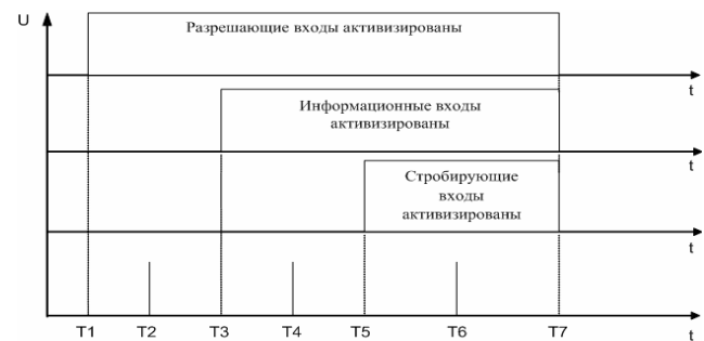
Рисунок 2 – Последовательность подачи активных уровней на входы цифровых микросхем
