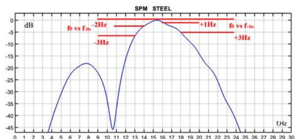
Рисунок 5 – Спектр сигналу-відгучу від сталюого зразка з позначеними амплітудними значеннями обвідної спектру
