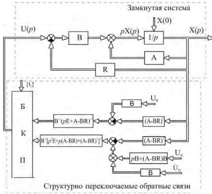
Рис. 3. Структурная схема системы управления вида (8) с дополнительными обратными связями (БКП – блок ключей переключения)
