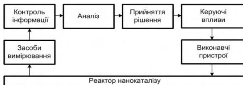
Рис. 5. Загальна схема системи керування процесом аерозольного нанокаталізу
