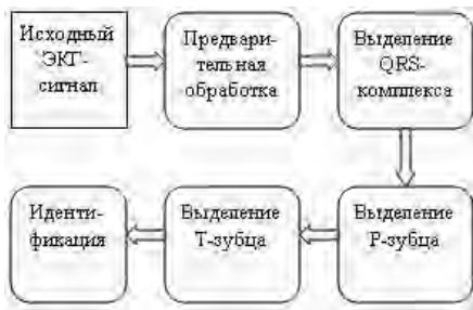
Рис. 3. Структура обработки ЭКГ-сигнала
