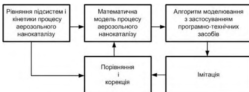
Рис. 6. Структура схема математичного моделювання
