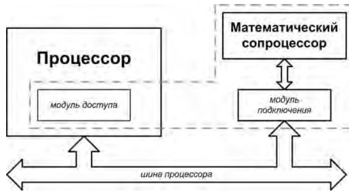
Рис. 3. Архитектура для подключения математического сопроцессора
